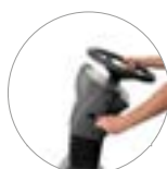
Columna de dirección regulable
